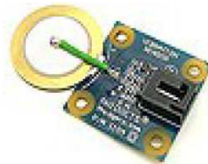
accéléromètre avec son disque piézoélectrique
