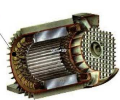
Rotor en structure de cage d'écureuil
