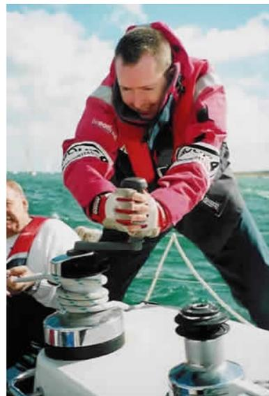
La tension des cordages peut être très importante lorsque le vent souffle dans les voiles. En enroulant la corde autour du tambour, les actions de frottement sur la corde diminuent progressivement la tension si bien que pour un enroulement important (plusieurs tours), l'effort peut être divisé par 10 ou 100. Le skipper peut alors maintenir ou relâcher progressivement (régler) les cordages sans efforts importants.
