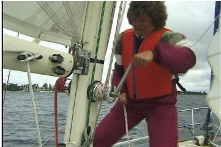
Un winch est un système mécanique utilisé sur les voiliers de plaisance pour aider à tendre les drisses (*cordes hissant les voiles*) ou les écoute (*cordes bordant les voiles*). Il s'agit d'un tambour libre en rotation dans un sens et bloqué dans l'autre, autour duquel la corde est enroulée. Le frottement permet alors de maintenir la corde sous forte tension par une action raisonnable de la part du skipper.
