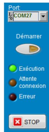
La Led verte « Exécution » est allumée lorsque la communication est établie entre le logiciel et la maquette. La Led GYRO-DRIVER de la maquette s'éteint. La Led Rouge « Erreur » s'allume si la connexion est inexistante ou si le port COM est absent ou incorrect.
