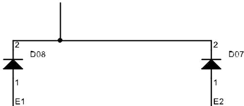
Les 2 diodes, avec R18 forment une porte OU analogique qui permet de combiner le défaut surintensité moteur et l'arrêt du moteur.
