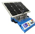
Comme le montre la figure ci-dessus, il comprend une **photopile** et des **photorésistances** montées en **pont diviseur de tension** dans un croisillon. Deux ponts sont utilisés, l'un pour détecter la position du soleil en azimut, l'autre pour détecter sa position en élévation.
