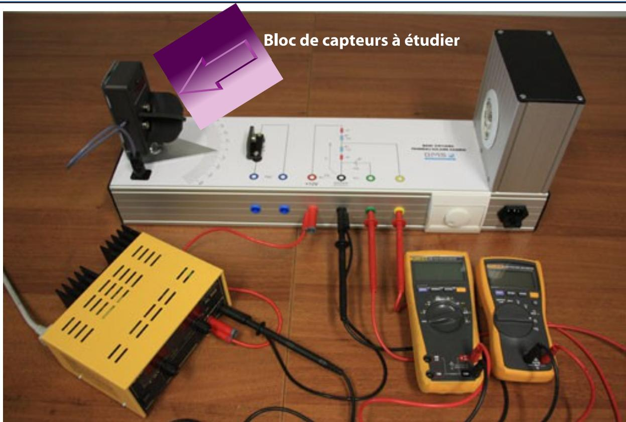
Figure 2.247 : Exploitation du banc d'étude des capteurs pour mettre en évidence la caractéristique de transfert du bloc de capteurs
