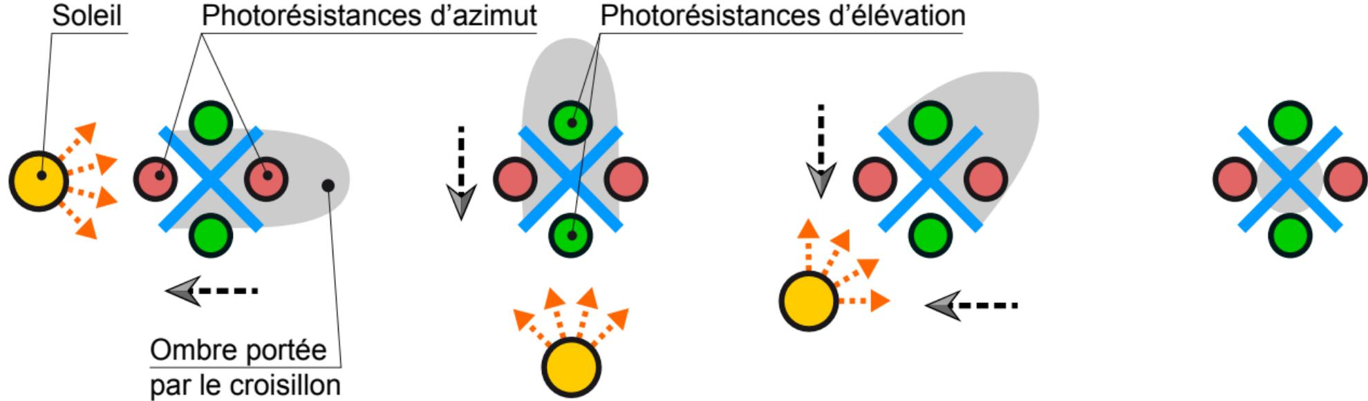
1 photorésistance d'azimut est éclairée : la tourelle se déplace en azimut vers le soleil
