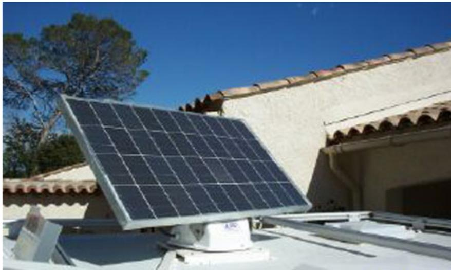
Figure 1.1-1 : Capteur solaire motorisé Phénix monté sur le toit d'un camping-car
