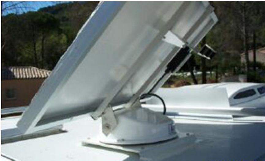
Figure 1.1-2 : Capteur solaire et son embase motorisée
