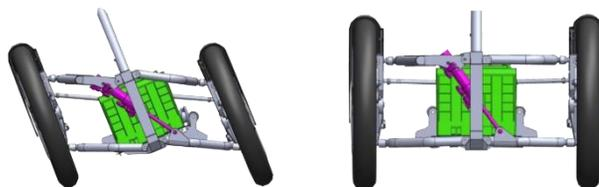
*Tilt Control System « TCS » : système breveté pour le contrôle de l'inclinaison*
