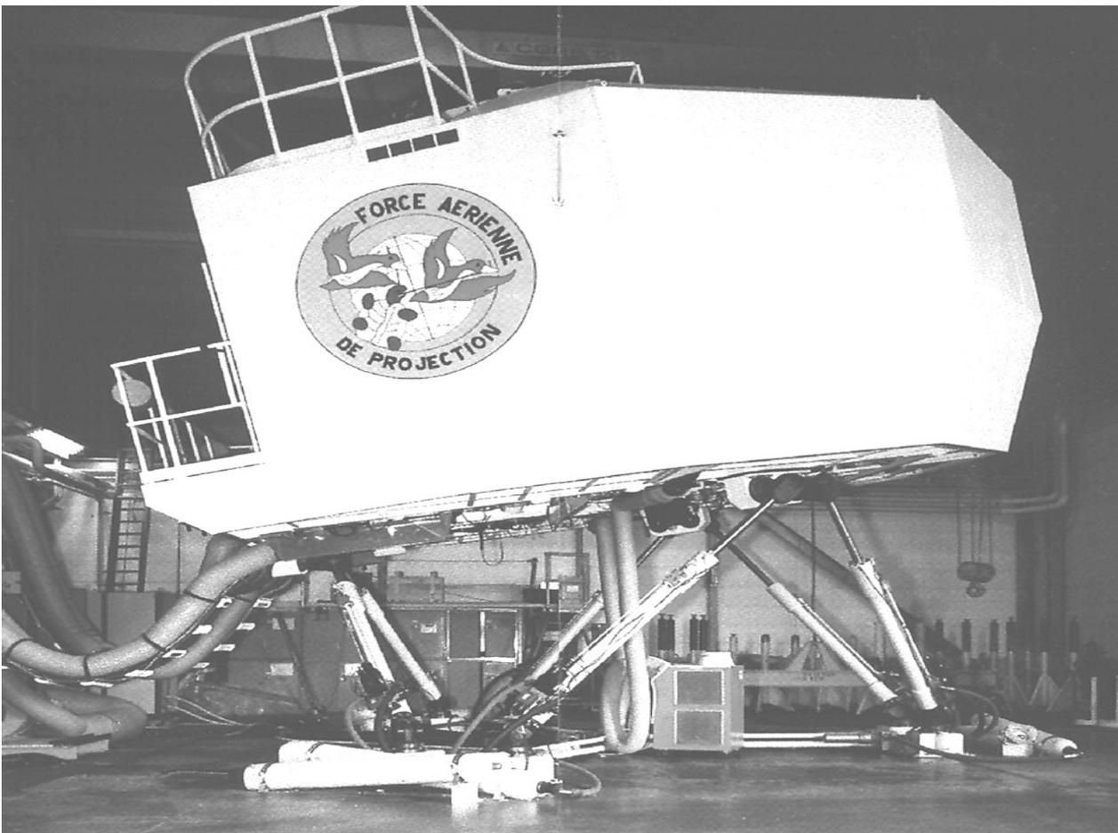
**Figure 1 : Mouvement cabine Six axes**
