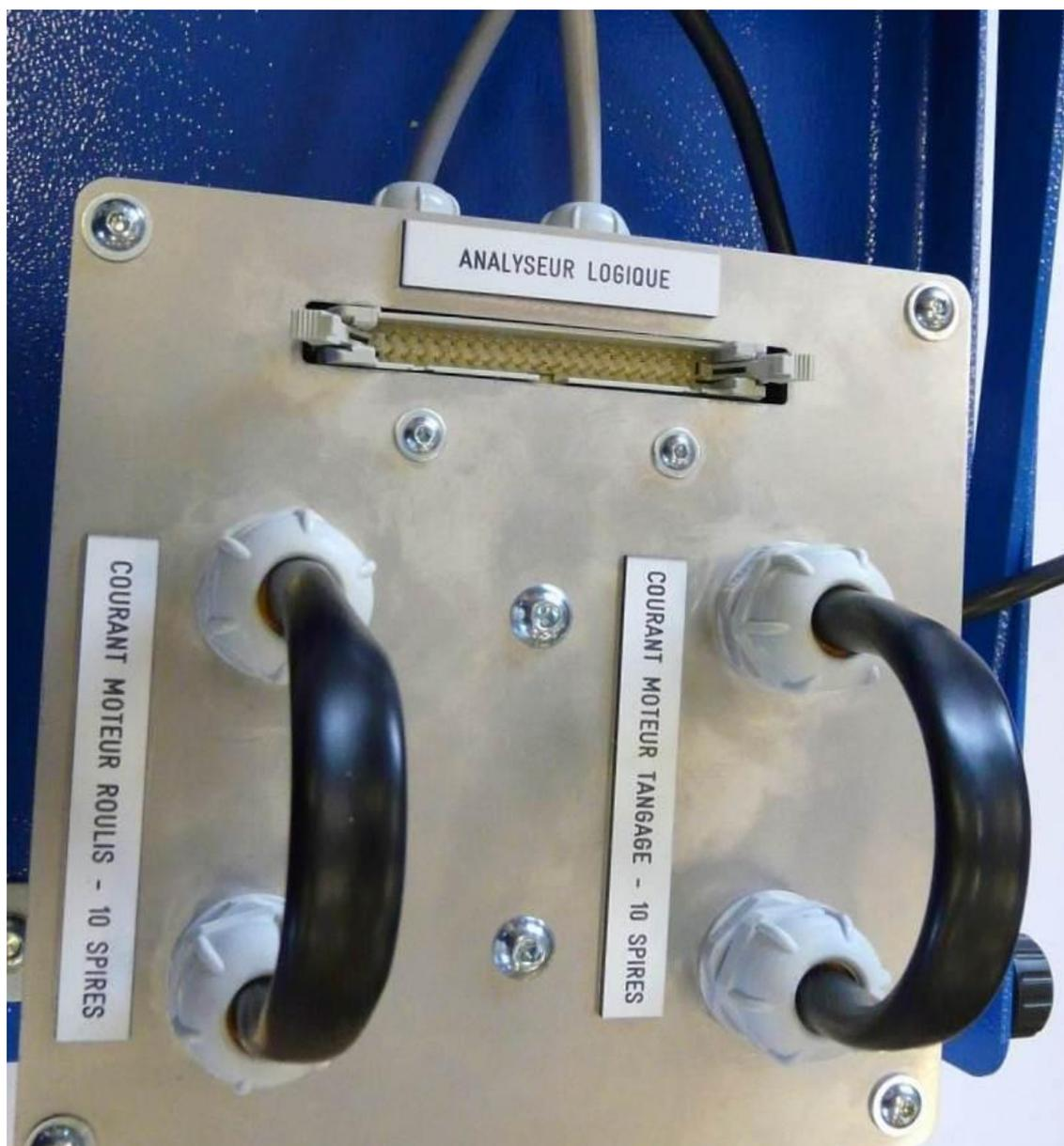
L'interprétation des trames SPI se fait avec l'analyseur logique (réf. ERM PR09). Relier le boîtier de mesure et l'analyseur logique avec la nappe fournie. Brancher l'analyseur logique sur un port USB du PC et lancer le logiciel LogicPort.
