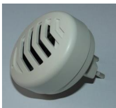
Générateur d'ultra-sons pour créer des perturbations
