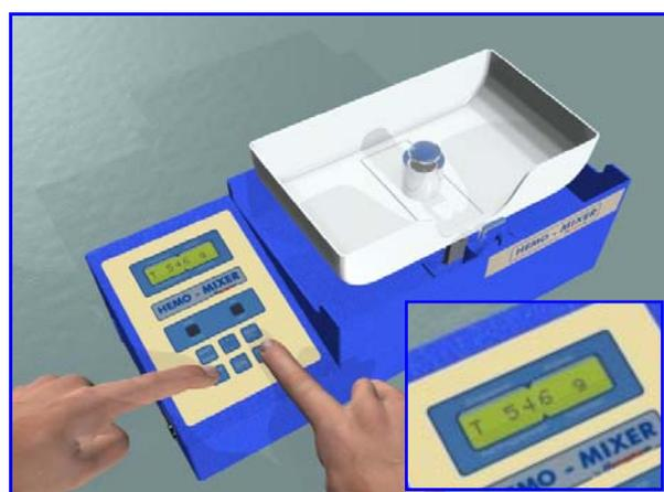
**La valeur affichée du poids posé sur le plateau doit avoir une précision de +/-5g**, si celle-ci n'est pas dans les tolérances effectuez un étalonnage à l'aide de l'interface PC.
