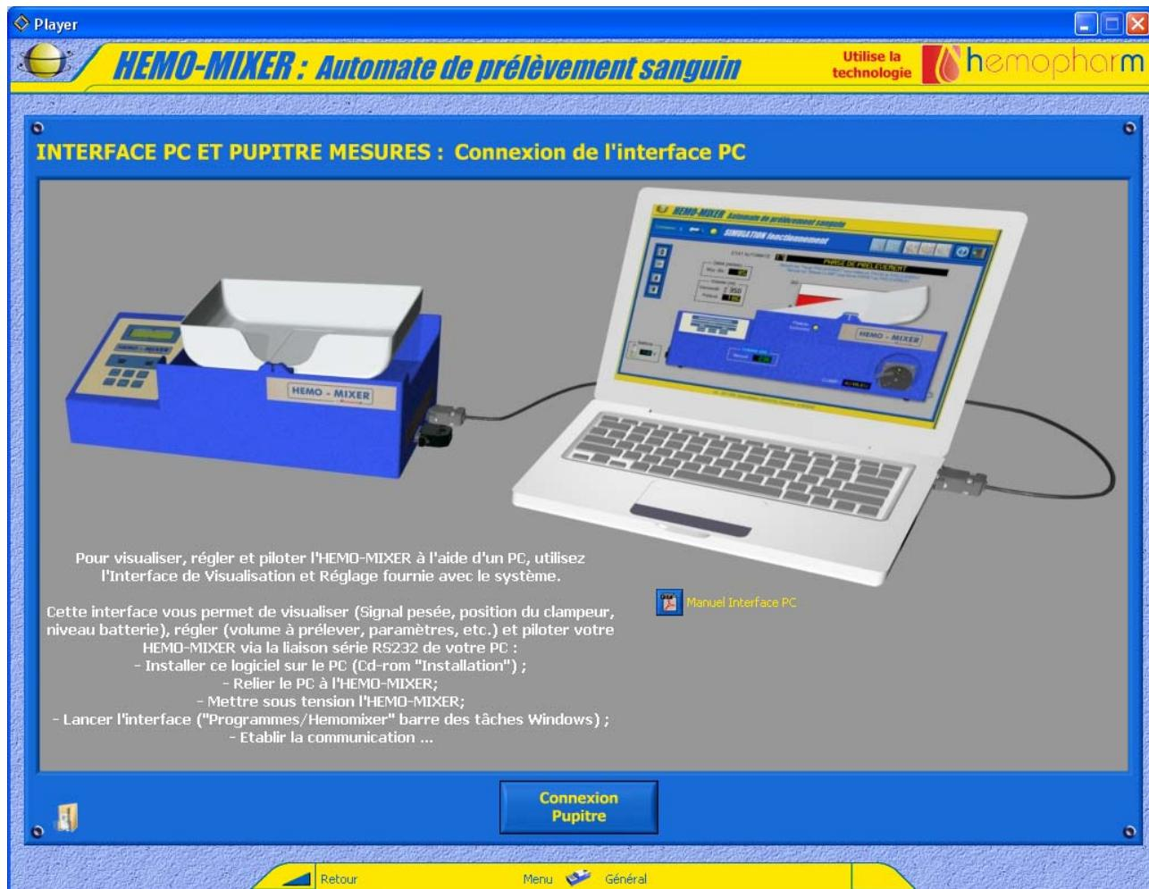
Cet écran décrit la procédure à suivre pour connecter l'interface PC ou le pupitre de mesures à l'HEMO-MIXER. Le basculement entre les deux configurations se fait par le bouton « Connexion Pupitre » ou « Connexion Interface PC » situé au centre et sous l'illustration.
