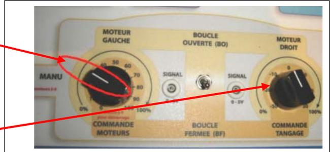
**Nota :** Le potentiomètre « COMMANDE TANGAGE » gère (dans cette configuration) la vitesse angulaire du balancier et non plus la position ; Il faudra donc réaliser un retour en position centrale du bouton pour obtenir l'arrêt du mouvement de rotation du balancier.
