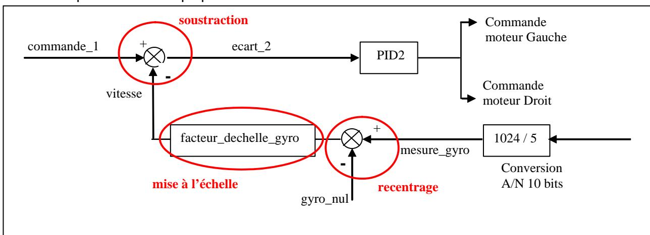
**Données** : les grandeurs qui proviennent de la consigne sont des grandeurs positives et négatives ; or l'étude de la partie 2 a permis de montrer que si l'on utilise la sortie analogique du gyromètre, l'information numérique qu'il délivre est codée sur 10 bits, donc de 0 à 1023. Il s'agit donc non seulement d'effectuer une soustraction entre la consigne et la mesure, mais préalablement de recentrer cette mesure autour de zéro.
