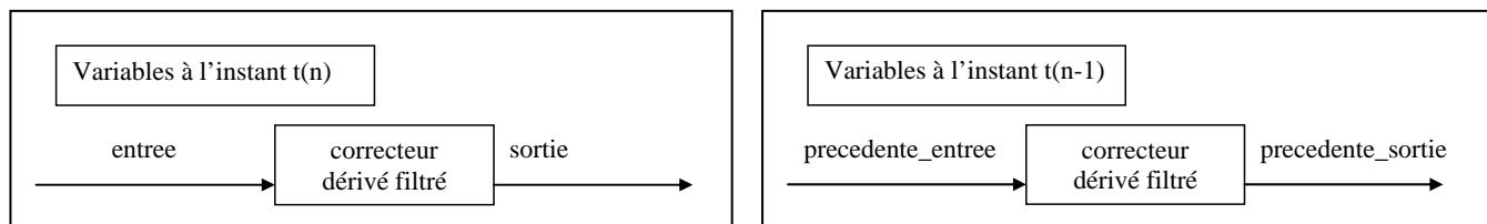
→ Réécrire l'équation de récurrence du correcteur en utilisant les variables d'entrée-sortie ci-dessus pour exprimer la sortie à l'instant t(n) .
