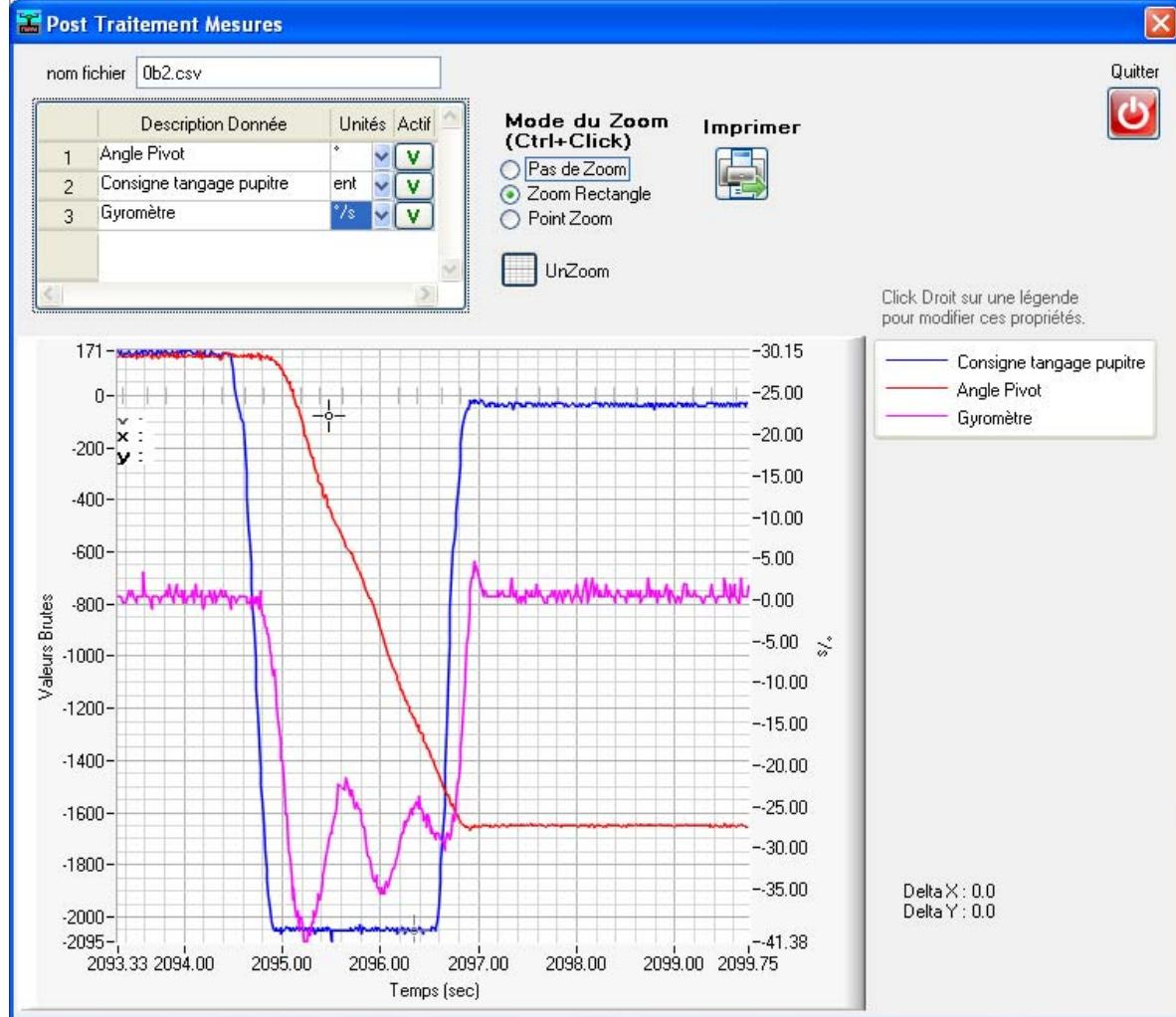
L'acquisition de la réponse à un créneau de consigne réalisé avec le potentiomètre du pupitre montre que le système n'est pas instable, même si la réponse (en vitesse angulaire) est un peu oscillante.
