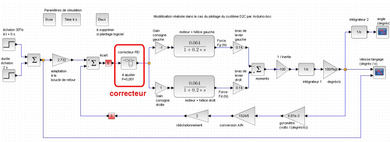
la « [Fiche\\_equations-de-recurrence](#) » fournit la méthode pour obtenir l'équation de récurrence qui va être utilisée pour programmer la partie « dérivé filtré » de ce correcteur.
