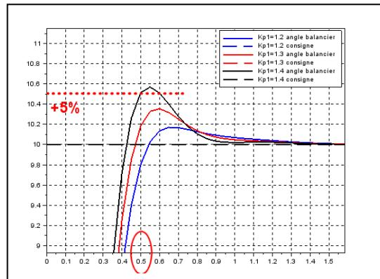
→ vérifier que l'ajout de la boucle interne a permis de rendre le système plus rapide par rapport au cas de la commande à une seule boucle de position étudié dans la phase 1, et de répondre au cahier des charges sur le critère de rapidité.
