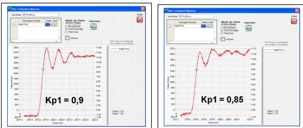
On observe sur le système réel est un peu plus oscillant, et qu'en premier recours, le coefficient Kp1 peut être abaissé à 0,85 environ pour obtenir un comportement plus satisfaisant du point de vue des oscillations :
