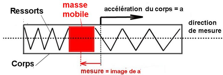
fonction pour laquelle l'accéléromètre a été conçu : « mesurer l'accélération selon la direction de mesure « dm » »
