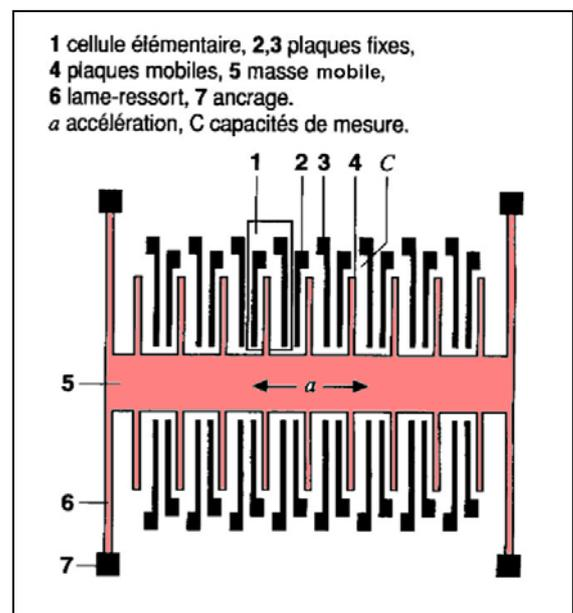
Un schéma équivalent qui représente bien le fonctionnement mécanique de l'accéléromètre à un axe est le « système masse-ressort » :
