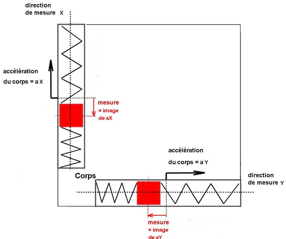
**4- Principe physique de la mesure d'accélération sur une direction :**
