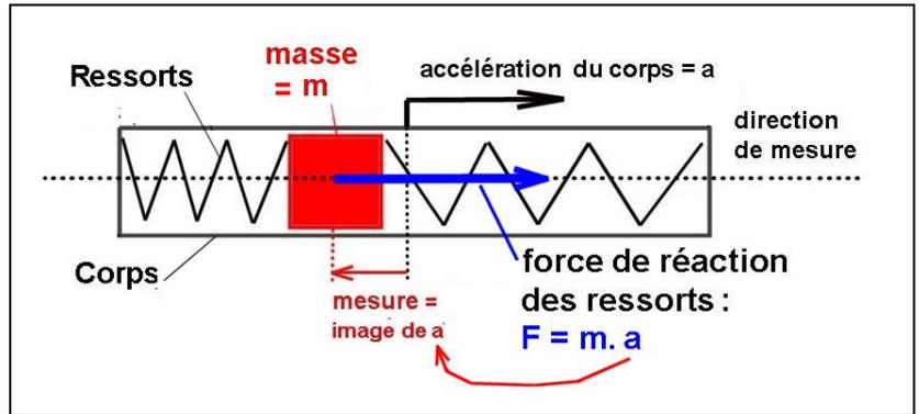
**5 - Utilisation de l'accéléromètre en « inclinomètre » :**
