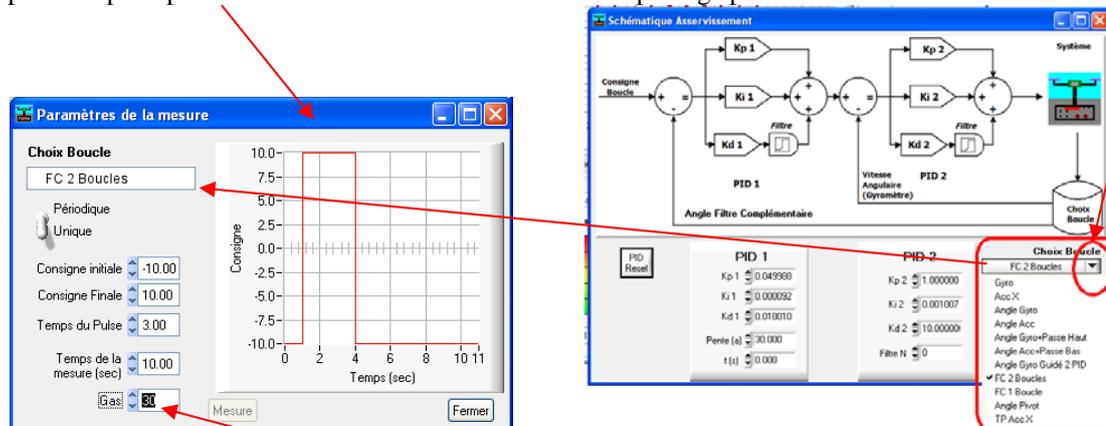
La valeur du régime des moteurs « Gas » doit être sélectionnée avec attention ; Il s'agit de choisir une valeur adaptée à l'expérimentation à réaliser ; les moteurs démarrent à partir de 18 % ; dans le cas où ce choix n'a pas d'importance, utiliser une valeur comprise **entre 20 et 25 %** pour limiter les nuisances sonores.
