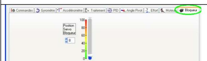
Cette grandeur est une commande de la position du servo-bloqueur ; elle n'est pas accessible pour le monitoring.
