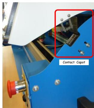
**Etape 4** : Sur le pupitre, déverrouiller l'arrêt d'urgence puis appuyer sur le bouton poussoir "Armer système". Un relais auto alimenté colle et la diode verte "variateur prêt" s'allume.
