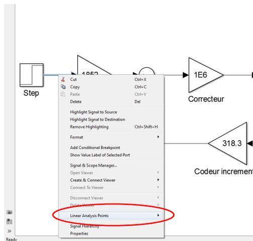
2. Par un **clik droit** sur la flèche du schéma bloc relative à la variable d'entrée, placer un point « Open-loop Output » (accessible par l'option "Linear Analysis Points").
