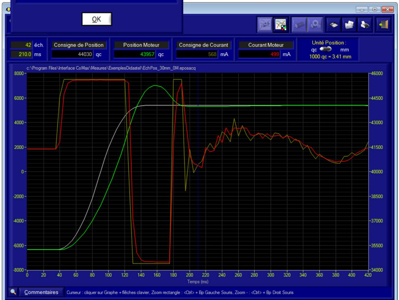
L'exemple ci-dessus est une réponse à un échelon de Position avec les mesures de Consigne de Position, Position Moteur, Consigne de Courant et Courant Moteur.
