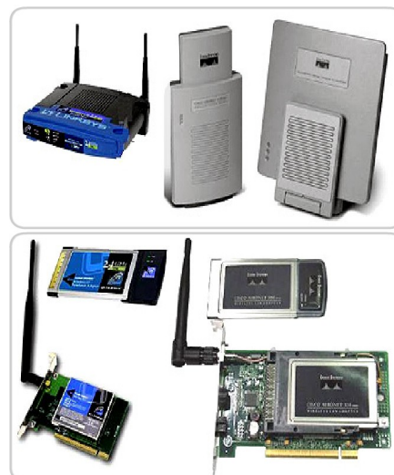
Fig. 65: Point d'accès et carte Wi-Fi
