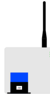
Fig. 69: Point d'accès Wi-Fi
