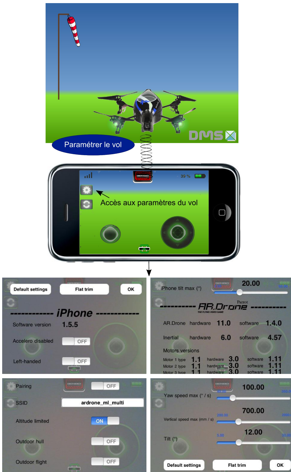
Fig. 24: Paramétrage du vol depuis la Station-Sol
