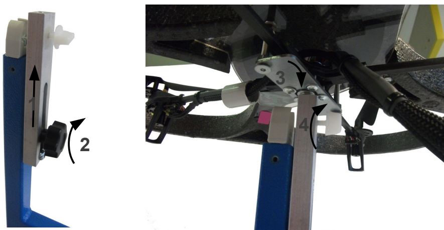
Fig. 110: Fixation de la croix centrale en position "Orienter"
